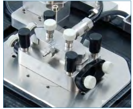
5mL 加热液体池 (室温到50°C)
