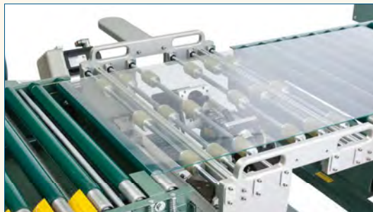
在线椭偏仪正在测量玻璃平板上的膜层
